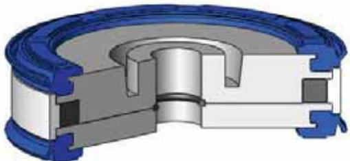
K58 es una junta de doble efecto de cinco piezas formada por un cuerpo de aluminio, dos juntas de estanqueidad de elastómero, un aro guía, un imán y una tórica para la estanqueidad interior.
