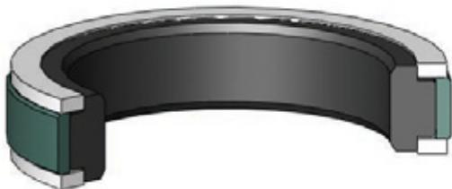
K19 Es una junta compacta de hidráulica pesada de doble acción de 4 piezas que consiste en un anillo de estanqueidad de PTFE con bronce, un anillo energizante de elastómero NBR y dos anillos de apoyo de termoplástico.
